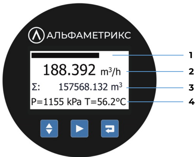
Рисунок 22 - Интерфейс управления расходомером
